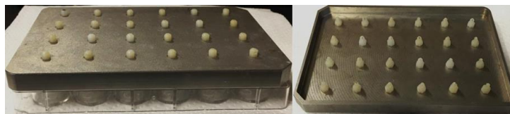
↑特注で作製したステンレス製の24ウェルプレートの上蓋(右図:内面)
